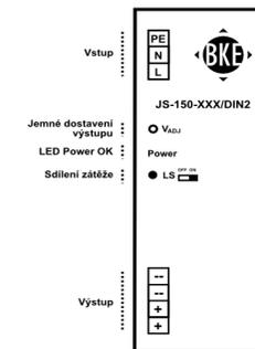
Výstupní napětí je možno dostavit (+/-5%) pomocí trimru na čelním panelu Vadj. Při paralelním spojení zdrojů je třeba přesunout přepínač LS (na čelním panelu) do polohy ON.
